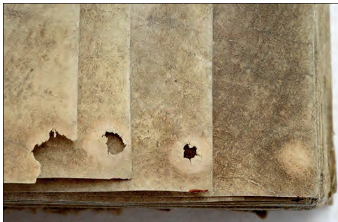
Il. 168. Graduale de tempore et de sanctis , BDP, sygn. L13; zbliżenia narożników kolejnych kart, obrazujące postępującą intensyfikację zniszczeń mikrobiologicznych (fot. przed podjęciem prac kons., J. Czuczko)
