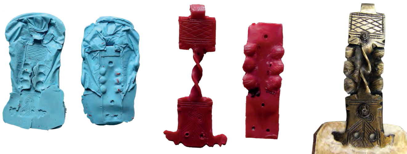
Il. 191. Silikonowa forma zdjęta z zachowanej zapinki Graduału L13, odlew z wosku formierskiego i zrekonstruowana zapinka wykonana metodą wosku traconego po patynowaniu (fot. D. Jutrzenka-Supryn, A. Tomaszewska-Szewczyk)
